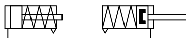
Figura 2.9. Cilindros de simples ação com retorno (esq.) e avanço por mola (dir.)
